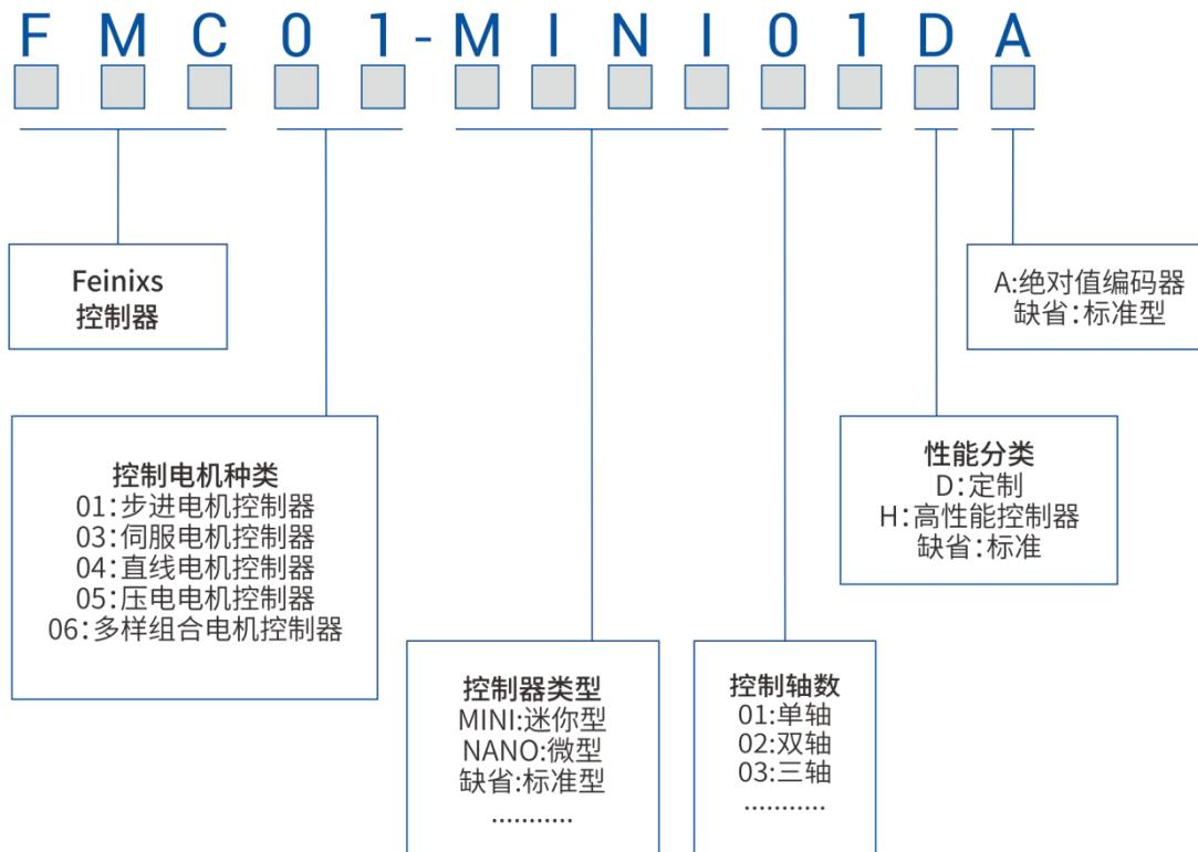
例：FMC04-Mini01 表示：直线控制器+迷你型+单轴+标准控制器
