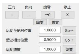
运动控制主要包括以下几种方式:搜零、点动、相对运动、绝对运动。
