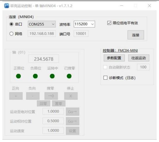
运行软件时先选择对应的控制器型号,如图所示,选择 "FMC04-MINI",点击"确认",界面跳转到软件主界面如上图所示。
