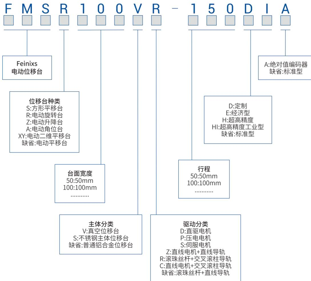
例：FMSR100V 表示：电动旋转台+台面宽度 100mm+步进电机+真空位移台。
