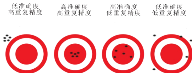
图 1. 准确度与重复精度的区别
