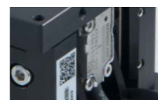
高精度光栅尺 为精确定位提供保证
